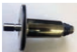
شکل ۱۱- روتور داخل محفظه فولادی
