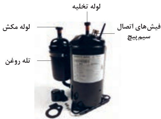
شکل ۱۶- اجزای خارجی کمپرسور
