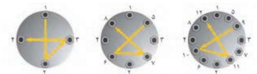
شکل ۲۳- ترتیب سفت کردن پیچ‌های فلنج
