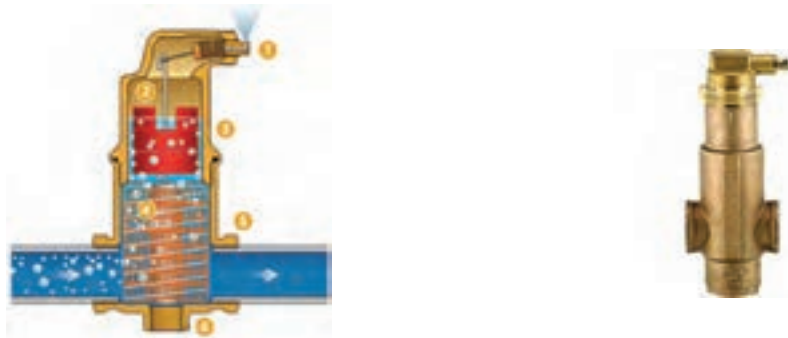
شکل ۲۰- شیر هواگیری (ایرونت)
