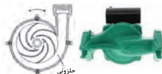
شکل ۷- پوسته حلزونی در پمپ خطی و زمینی
